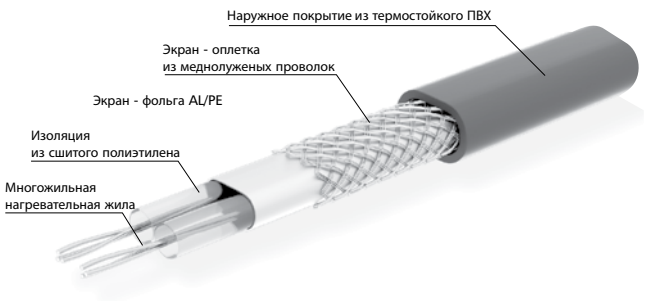
Конструкция нагревательного кабеля ELEKTRA VCD
